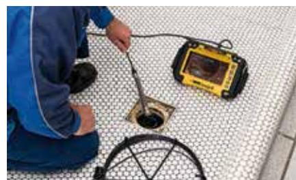
Ich arbeite mit einem Superleichten, handlichen Kamera-Inspektionssystem zur kostengünstigen Inspektion und Schadenanalyse von Rohren, Kanälen, Schornsteinen und anderen Hohlräumen. Auch zur Inspektion nach Rohrreinigungsarbeiten und zur Abnahme von Neuinstallationen oder Reparaturen. Dokumentation von Bildern und Videos mit Sprachaufzeichnung auf SD-Karte. Rufen Sie mich an, falls sie eine Rohrleitung zu inspizieren haben.
